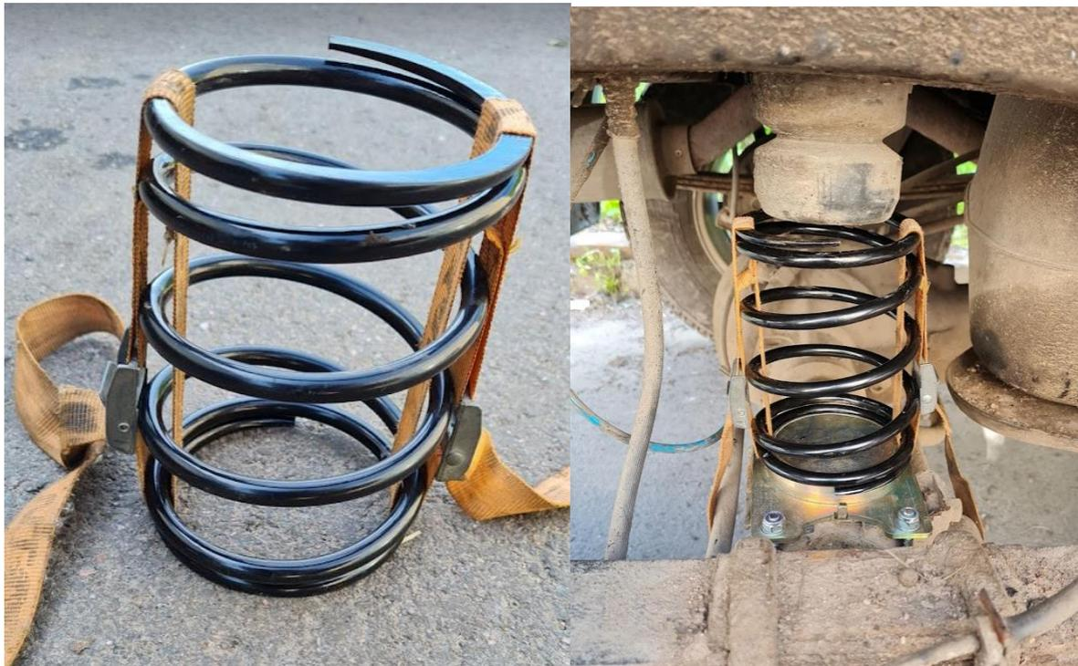
5. Освободить пружину от стяжных ремней или пружинных стяжек.
