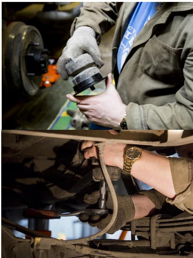
3. Установить нижнюю чашку на площадку под отбойником. Закрепить чашку при помощи двух стремянок (идут в комплекте) и гаек с шайбами, при этом чашку сдвинуть максимально от колеса, так чтобы стремянка уперлась в площадку отбойника.
